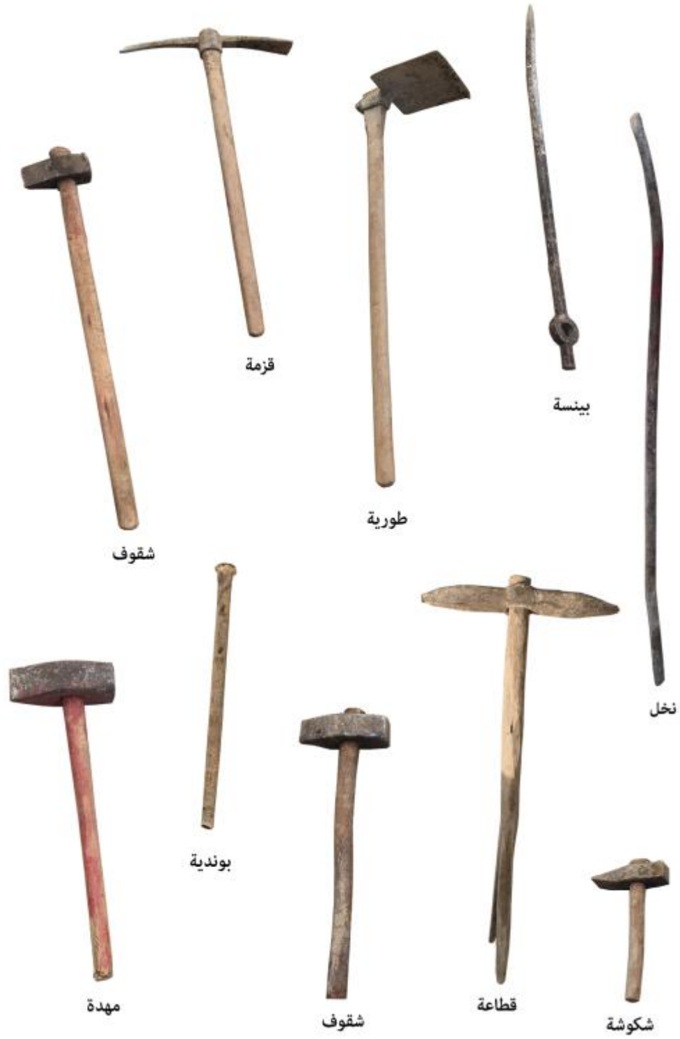
رسم توضيحي رقم (14): أدوات تقليدية يستخدمها السيد رائد فايق دار فرحات لإنشاء السناسل التقليدية.
